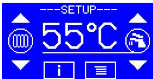
ЗАДАВАНЕ НА ЖЕЛАНАТА ТЕМПЕРАТУРА НА ПОДГРЯВАНЕ НА БГВ
