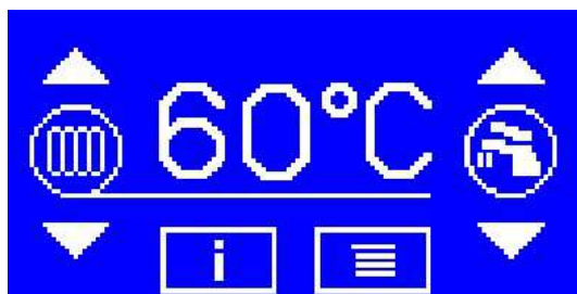
ПОКАЗВАНЕ НА ТЕМПЕРАТУРАТА НА ОТОПЛИТЕЛНАТА ВОДА
